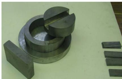
Рис. 1. Штамповая оснастка для проведения экспериментов по пластической осадке тонкой полосы
